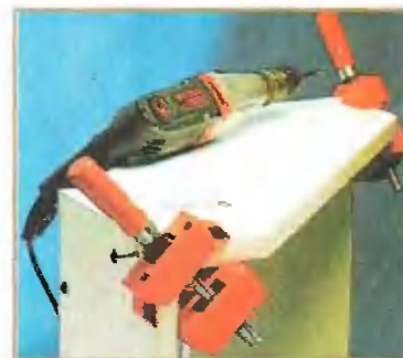
Рис. 7. Концы (с резьбой) ручки-скобы вставляют в заранее просверленные отверстия, надевают на них шайбы и закрепляют гайками. Выступающие из гаек кончики удаляют напильником.
