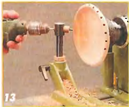
13 Специальное приспособление для сверления и делительная головка позволяют с одинаковым шагом просверлить 24 отверстия Ø6 мм.
