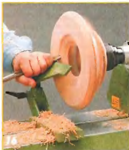
16 Обтачивают и «пробивают» отверстие в заготовке для кольца с помощью фасонного или желобчатого резца предельно осторожно.
