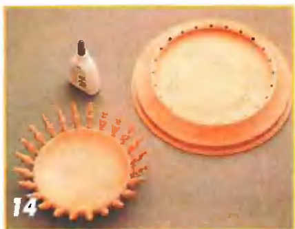
14 Аналогично тарелке вытачивают и кольцо чаши, а также сверлят отверстия такого же диаметра. Теперь можно вклеить «балясины».
