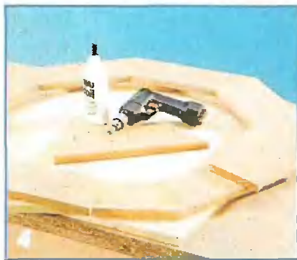
Оба слоя карниза (детали 3), изготовленные из ДВП средней плотности, соединяют шурупами и кладут на размеченную плиту.
