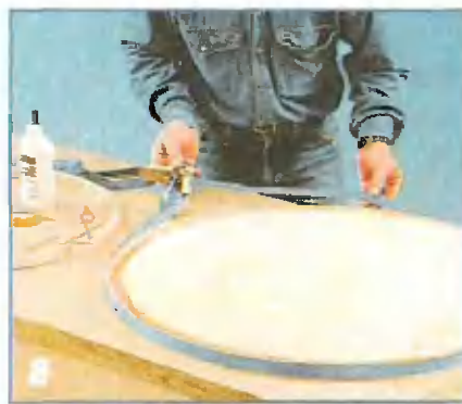
Стяжной ремень используют при фанеровании кромок шпоном толщиной 3,1 мм.
